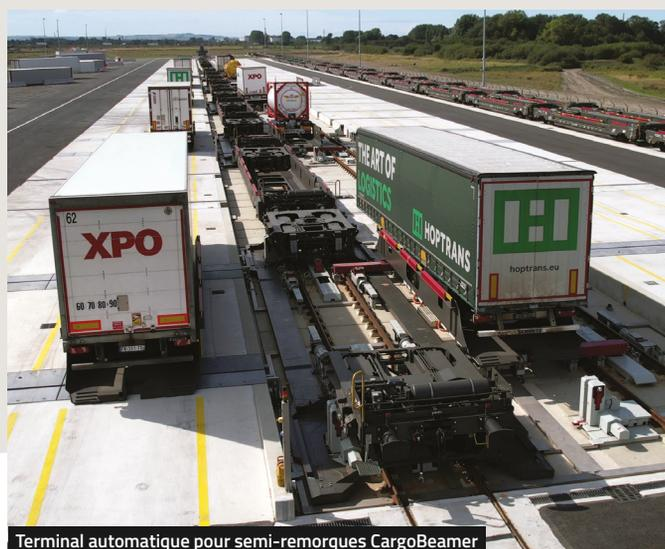
Terminal automatique pour semi-remorques CargoBeamer
